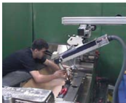
Laserowe spawanie 40 tonowej matrycy na zderzak samochodowy.
