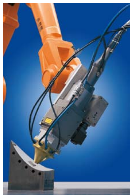
Robot laserowy spawaa automatycznie proszkiem. To jedno z wielu znakomitych rozwiązań.
