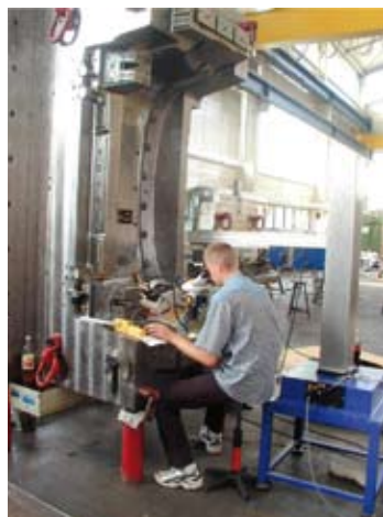
Spawanie laserowe przy 20 tonowej formie na zderzak.
