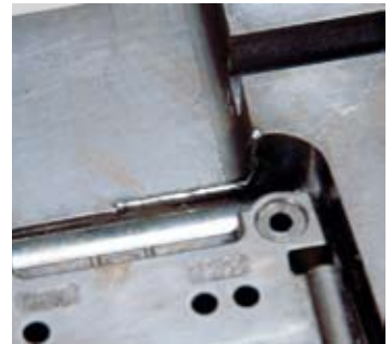
spawanie wkładki matrycowej obudowy telefonu komórkowego
