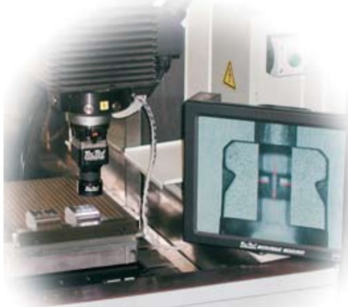
Przykład pomiaru z 55-krotnym powiększeniem na 15' mon torze
