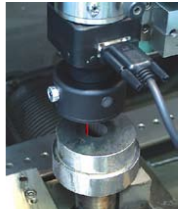
Pomiar z 55-krotnym powiększeniem i laserowym promieniem wskaźującym LSP.
